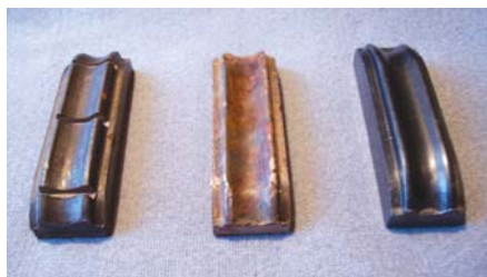
5 Контакты троллейбуса, справа — углеродный, слева — чугунные. Прорези — для сцарапывания льда
