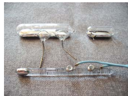
6 «Свинки» и градусник, в котором ртуть замыкает два контакта
